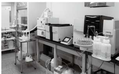
試料中の元素を測定する原子吸光分析装置
